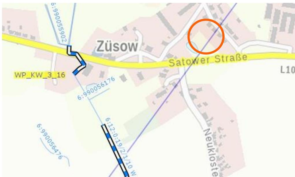
Abbildung 6: Darstellung des Grundwasserkörpers (blaue Linien) des Oberflächenwassers im Plangebiet (orangener Kreis) mit Darstellung der Rohrleitungen für Regenwasser (blauweißgestrichelt) und offenen Gräben (hellblau) (Geodatenportal M-V 2022).
