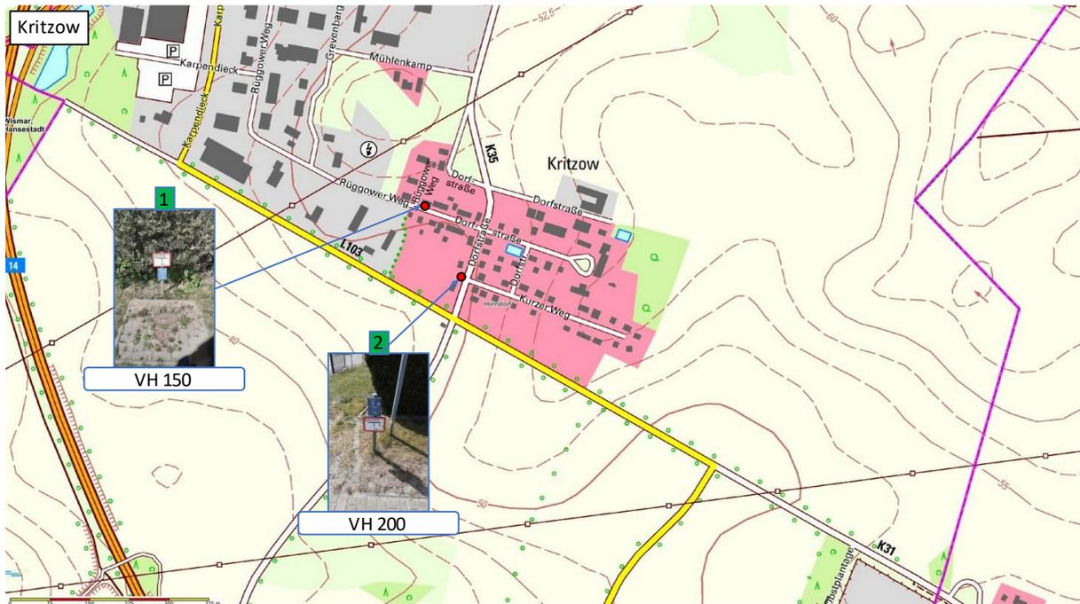
Abbildung 4 Löschwasserentnahmestellen Ortsteil Kritzow [1]
