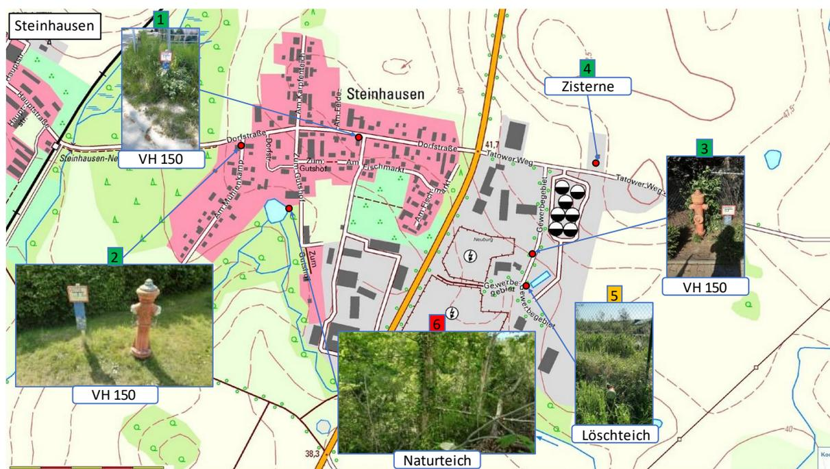
Abbildung 13 Löschwasserentnahmestellen Ortsteil Steinhausen [1]
