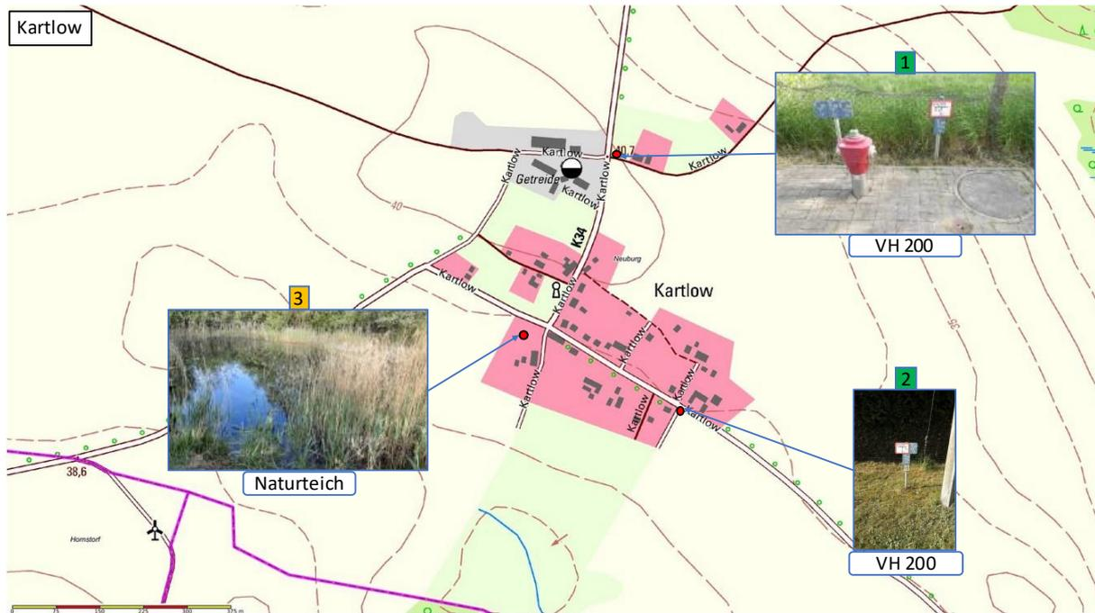
Abbildung 4 Löschwasserentnahmestellen Ortsteil Kartlow [1]
