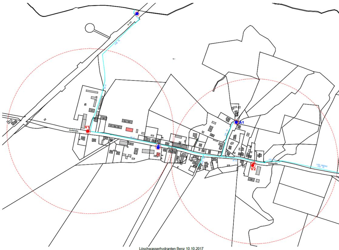
Abbildung 18 Löschwasserhydranten Ortsteil Benz
